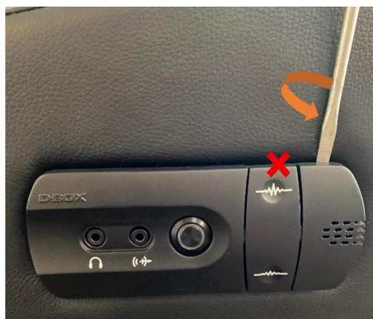
**ÉTAPE 2 :** Retirez le microphone de sa prise. À l'aide d'un tournevis plat, poussez doucement les quatre (4) languettes (une à la fois) pour détacher la planche de la plaque de moulage :
