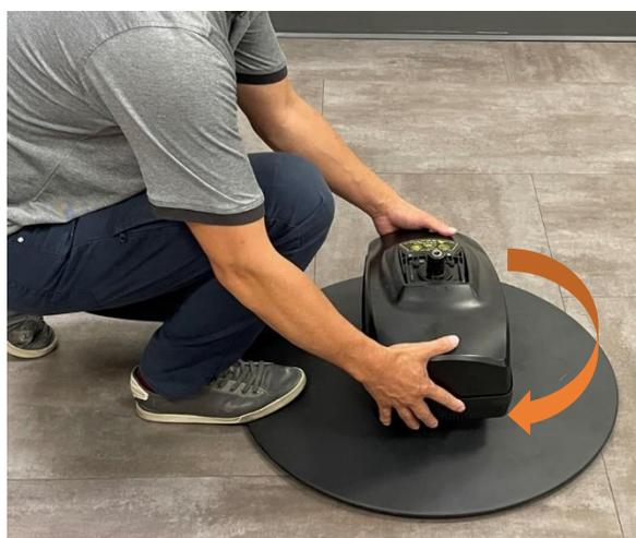
**ÉTAPE 7 :** Insérez le nouveau module haptique dans le trou de la base circulaire :
